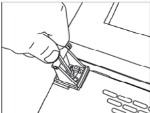
10: Skift over hengslepinnen til det nye nedre hengsle.
